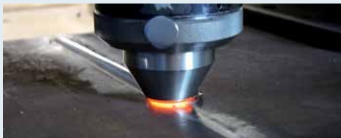
Reibrührschweißen von Stahl
